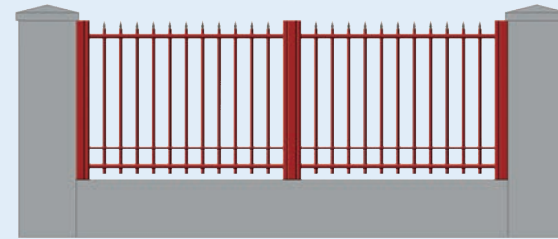
CLÔTURE MIXTE AVEC LISSE INTERMÉDIAIRE BASSE
